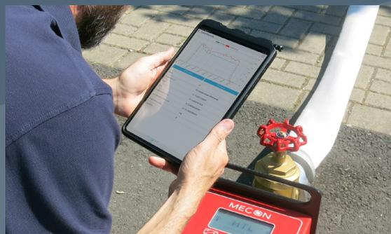
Der Messvorgang kann neben dem gut ablesbaren Display jetzt auch über die praxiserprobte App der Firma wasserkarte.info gesteuert werden. Alle Messdaten für Druck, Durchfluss, Temperatur und Trübung werden live vom Hydrantentestgerät in die App übertragen. Die Messprotokolle sowie Diagramme werden direkt als Vorschau angezeigt. **Der ganzheitliche Lösungsansatz für die Hydrantenwartung von der Dokumentation, Planung, Lokalisierung, Leistungsfähigkeit bis hin zur Instandhaltung.**
